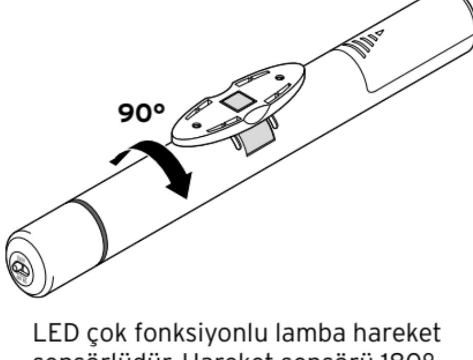
LED çok fonksiyonlu lamba hareket sensörlüdür. Hareket sensörü  $180^\circ$  kadar çevrilebilir.
