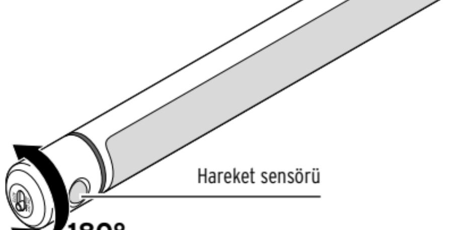
Hareket sensörünü öne veya arkaya doğru ne kadar döndürdüğünüzde bağlı olarak  $110^\circ$  açıyla maksimum 3 m mesafeye kadar olan hareketleri algılayabilir ve LED lambayı devreye alabilir.
